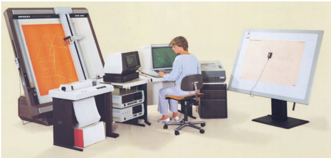
Abb.6 WILD GEOMAP konkrete Darstellung einer Gerätekonfiguration. Eine Operateurin überwacht und organisiert den Verkehr der Daten von einem zum anderen Gerät. Reproduktion aus: Geomatik Schweiz (119/3-4), 2021, S. 57.
